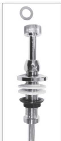
Art. 500 34 34 • Ligação para pias ajustável Com tubo de cobre Ø 12 mm comprimento de 500 mm Uma extremidade com porca de ligação 3/4" e outra extremidade com porca fêmea 3/4" Connection for Sinks , adjustable incl. C.P. Copper Tube Ø 12 mm, length 500 mm, one End with C.P. Nut 3/4", other End with female Thread 3/4"
